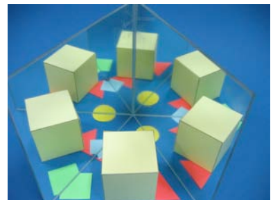
Klappspiegel mit 60^\circ : Alles passt wieder und man sieht fünf Spiegelbilder.
